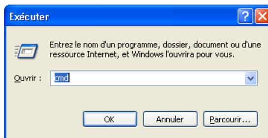
Une fenêtre commande dos apparait. Saisir la commande 'ipconfig'.
